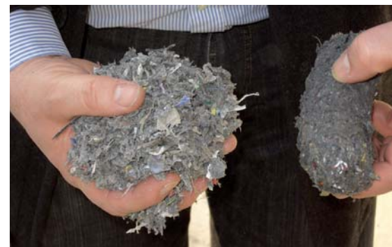
CSR densificado y triturado a 10 mm en comparación con RDF solo densificado
